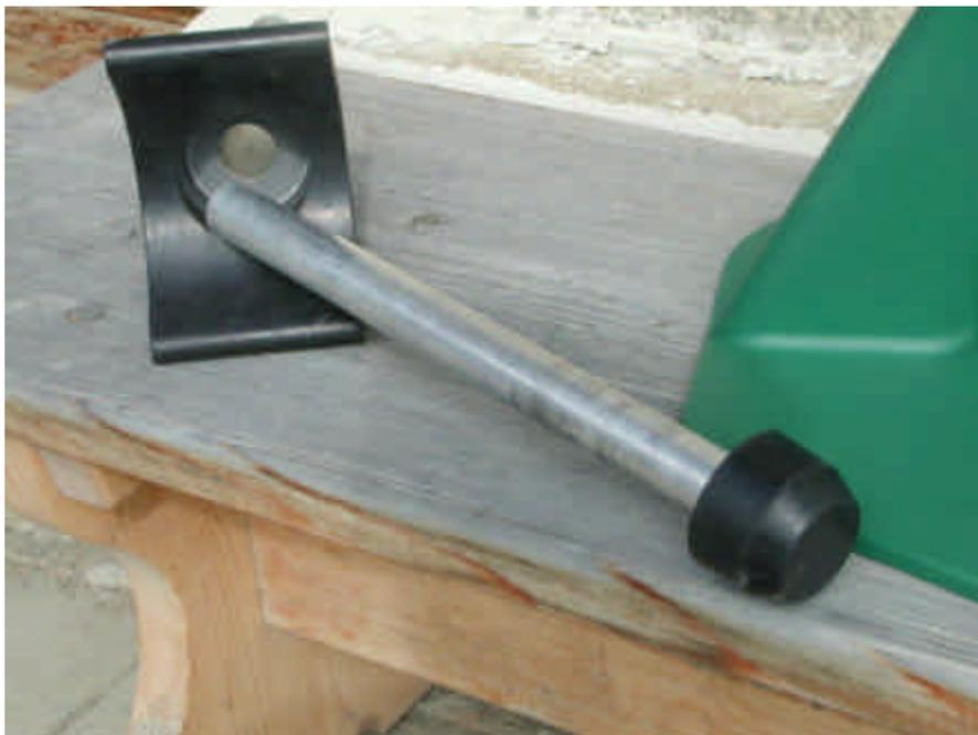
Er wird mit einer klappbaren Feststellschraube arretiert. Im Normalzustand wird die Auflegesohle genutzt.
